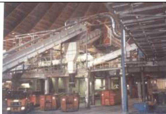
Fig.7 – O lixo recolhido das casas é misturado com galhos, podas e varredura de rua. Os galhos passam por trituradoras de galhos. Levado por correias, passam por coletores de metais e despejados nos caminhões que encaminham o material para a Usina de Compostagem.
